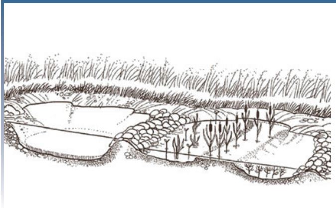
4 paveikslėlis. Sedimentacijos tvenkinėlio principinė schema
