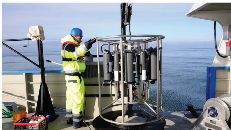
18 paveiksėlis. Ėminių paėmimo įranga – batometrų rozetė su CTD zondų.
